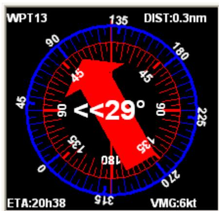
Ce répétiteur permet de visualiser l'écart de route et les différents autres paramètres relatifs au waypoint de destination. Le GPS suffit pour ce répétiteur. Celui-ci est composé des informations suivantes :
